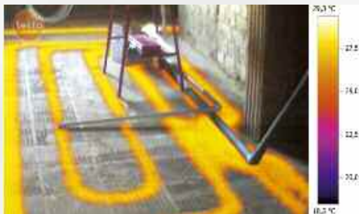
Con TwinPix se visualiza el estado de las tuberías ocultas en la imagen real
