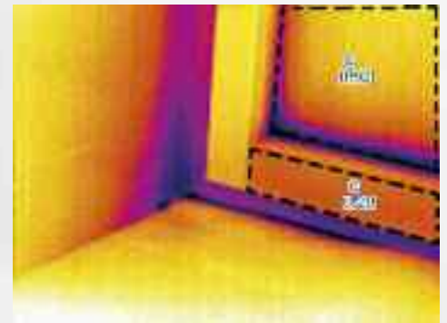
Configurar la emisividad por área permite un análisis más preciso.
